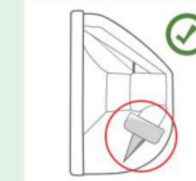
La válvula está girada a la alineación adecuada y se encuentra recta y presionada firmemente sobre la base de la válvula.
