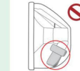
La válvula desalineada provoca la apertura de la válvula.
