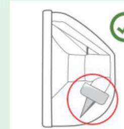
Das Ventil wird in die richtige Ausrichtung gedreht, sitzt gerade und wird fest auf die Ventilbasis gedrückt.
