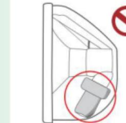
Eine Fehlausrichtung des Ventils führt zum Öffnen des Ventils.
